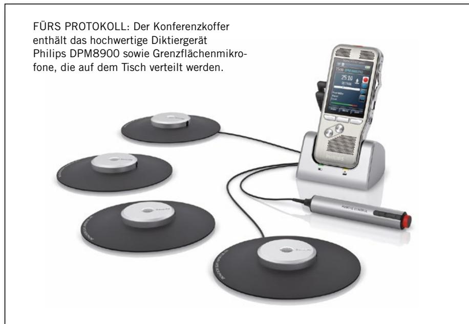
FÜRS PROTOKOLL: Der Konferenzkoffer enthält das hochwertige Diktiergerät Philips DPM8900 sowie Grenzflächenmikrofone, die auf dem Tisch verteilt werden.
